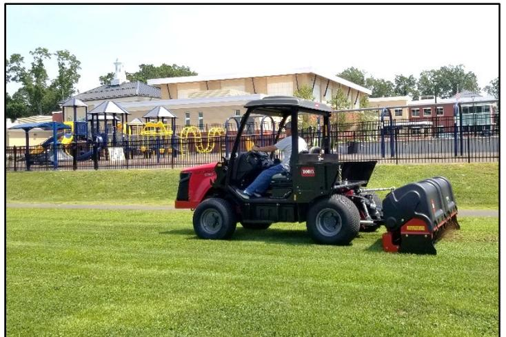
Figura 4. Utilice solo unidades de cultivo de núcleo accionadas por Power Take-Off (PTO) y de funcionamiento vertical. Estas unidades pueden proporcionar una profundidad de penetración constante a 3-4". Evite los cultivadores de núcleo tipo tambor siempre que sea posible debido a su profundidad de penetración poco profunda e inconsistente. Foto por Alyssa Siegel-Miles.
