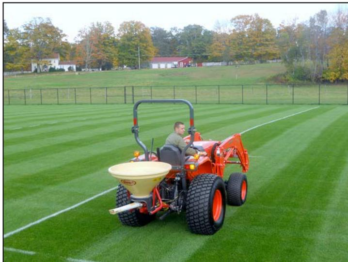
Figura 3. Considere el uso de esparcidores de transmisión de alta capacidad para cubrir áreas grandes rápidamente.
