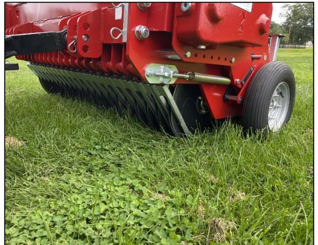
Figura 9. En ausencia de tráfico, las semillas deben aplicarse utilizando una sembradora de púas que maximizará el contacto de la semilla con el suelo al mismo tiempo que minimiza el daño al soporte de césped existente.
